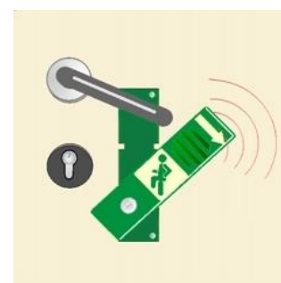
Schwenk-Türwächter (Quelle: Firma safetyline)
